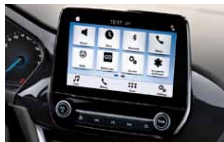
Radioodtworacz z Ford SYNC 3 oraz 8" kolorowy wyświetlacz dotykowy
